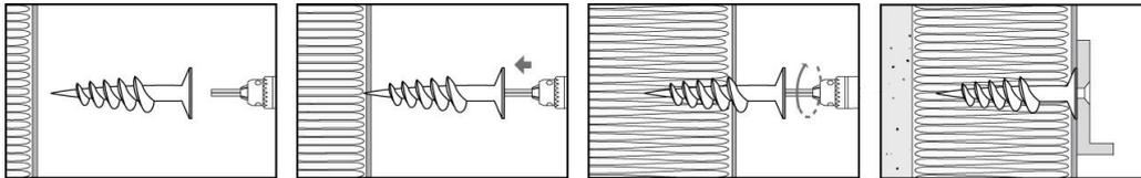
Su materiali isolanti non intonacati avvitare il tassello senza foratura di grosso, con avvitatrice a batteria oppure con cacciavite / On non-plastered insulation materials install the fixing, without pilot hole, using electric tool or screw driver.
